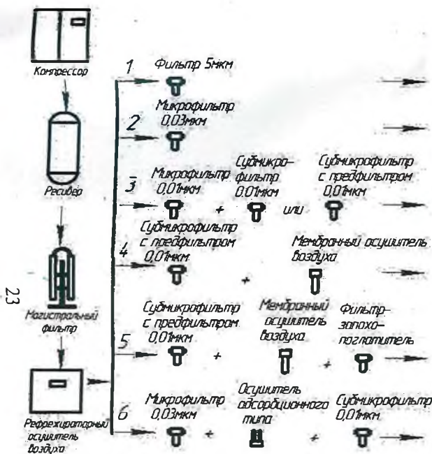
Рисунок 8 Рекомендуемая схема подготовки сжатого воздуха
